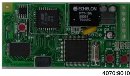
Bild 21: Feldbus-Modul (Beispiel: LON-Modul)
